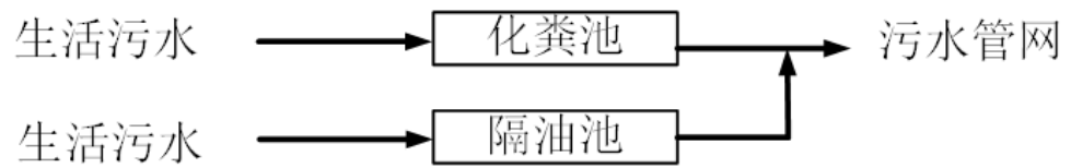
图 4-1: 污水处理流程图
